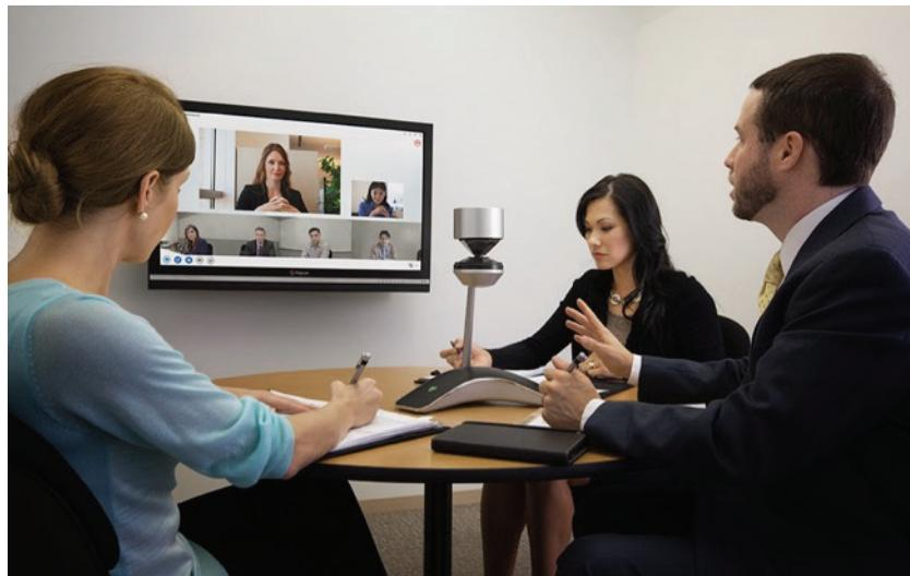
Les systèmes Polycom CX5100 et CX5500 comprennent une caméra à 360 degrés (panoramique) avec son intégré (microphones et haut-parleurs) compatible avec Microsoft Skype Enterprise (anciennement Lync).<sup>4</sup> Le CX5100 est le modèle standard, tandis que le CX5500 comprend une pile SIP (prenant en charge les appels VoIP indépendamment de Skype Enterprise), ainsi qu'un écran/une interface utilisateur tactile couleur.
